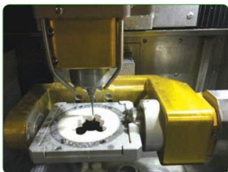
تصویر ۲: دستگاه MAC/DAC شرکت SYSXA در حال تراش فریم‌های زیرکونیا
