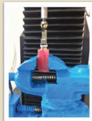
تصویر ۱ : نمونه در دستگاه اینسترون تحت کشش قرار گرفته
