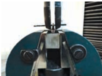
شکل ۲: انجام تست کشش توسط دستگاه یونیورسال
