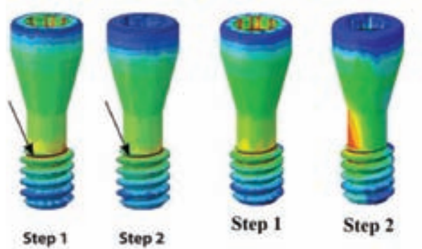
تصویر ۶: نمای شماتیک توزیع تنش مایز در پیچ اباتمنت ایمپلنت mm4 (الف) و ایمپلنت mm8 (ب) (رنگ بندی بر اساس بزرگی مقادیر تنش به ترتیب: قرمز، نارنجی، زرد، سبز و آبی می باشد)
