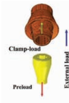
تصویر ۵: راستای پریلود (فلش قرمز)، نیروی کلمپ (فلش سبز) و مولفه محوری نیروی خارجی (فلش آبی)
